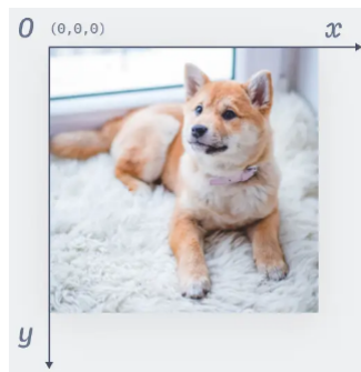
Figura 2.11: Convenção do sistema de coordenadas usado numa imagem [19].
