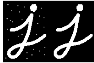
Figura 2.29: Operação morfológica de opening : imagem original à esquerda; resultado da aplicação à direita [34].
