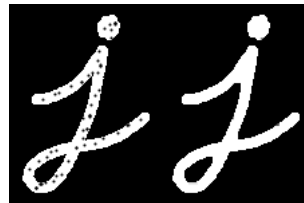
Figura 2.30: Operação morfológica de closing : imagem original à esquerda; resultado da aplicação à direita [34].
