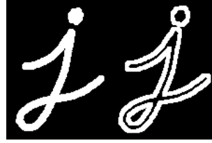
Figura 2.31: Operação morfológica de gradiente morfológico: imagem original à esquerda; resultado da aplicação à direita [34].
