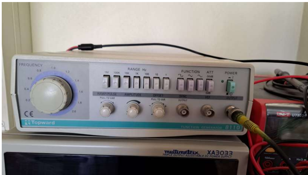
Figura 2: Gerador de sinais do Laboratório de Circuitos e Sinais Elétricos do ISEP
